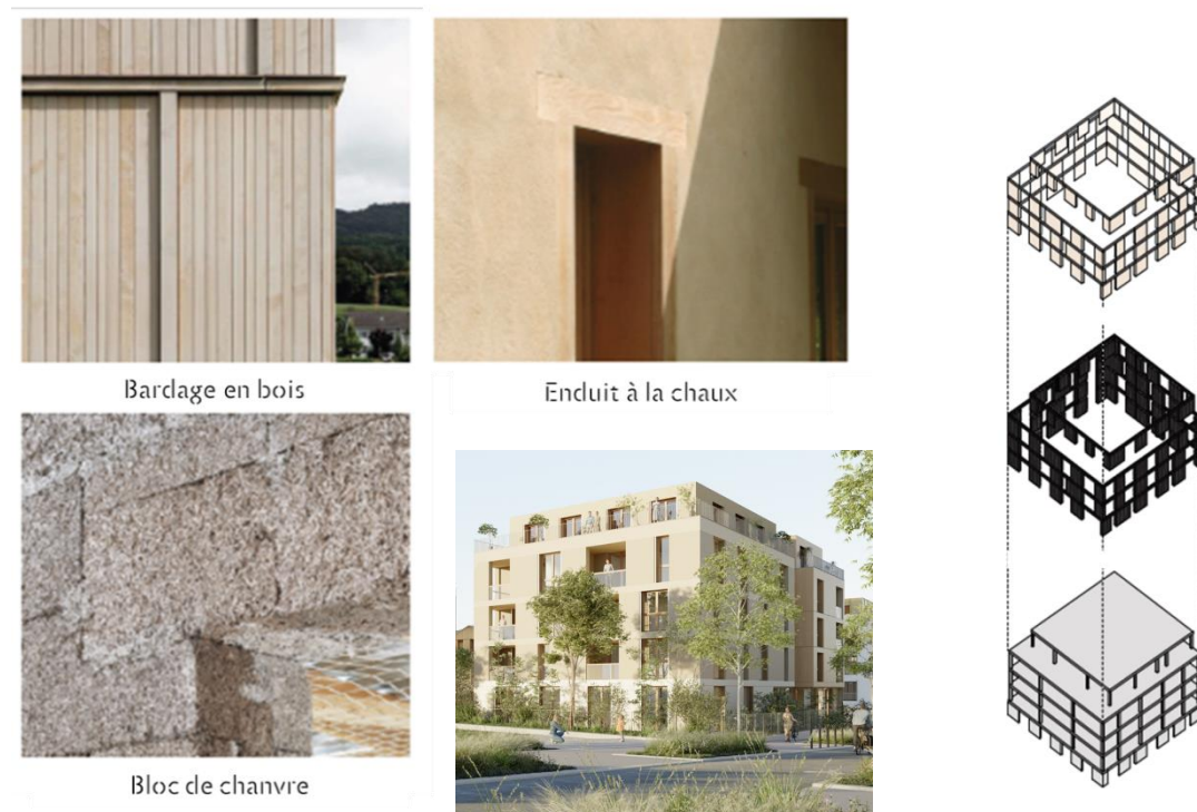
Figure 14 : Principe innovant des blocs de chanvre du programme immobilier ILOW
